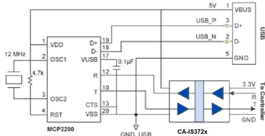
芯片 MCP2200 是一个 USB2.0 到 UART 的协议转换器。CA-IS37XX 系列是同类产品中最好的双向隔离器，具有显著的抖动性能，传输延迟比较低。耐压性能比较好
